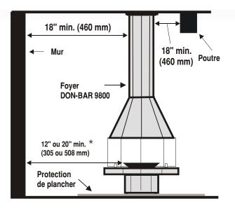
(\*) Si la cheminée préfabriquée installée a un diamètre intérieur de 10", le dégagement mural de 20" peut être réduit à 12".
